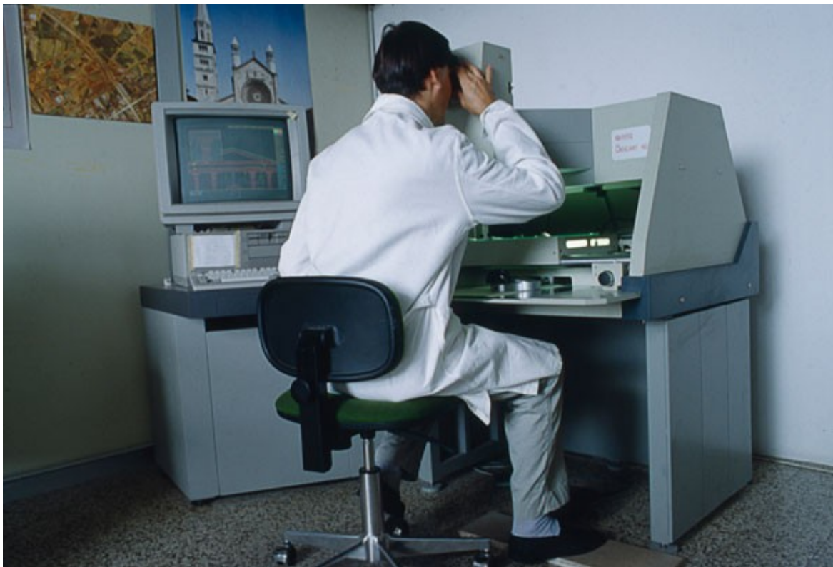
Restituzione fotogrammetrica di un violino.
